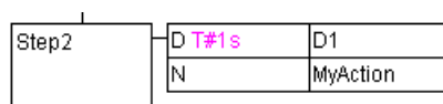
Figur 9: Ett exempel på en handling i ett funktionsdiagram i CoDeSys (jfr. Figur 7).
