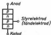
Schematisk uppbyggnad av tyristor med skikt av p- och n-typ
