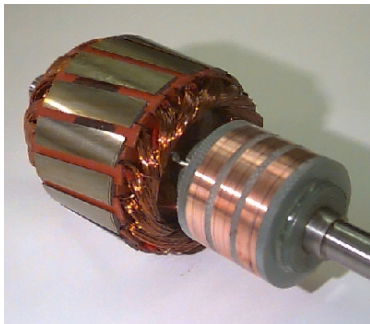
Figur: Exempel på släpringad lindad rotor (Polytechnic University of Japan), t.v. och burlindad rotor, t.h. (Wikimedia Commons)
