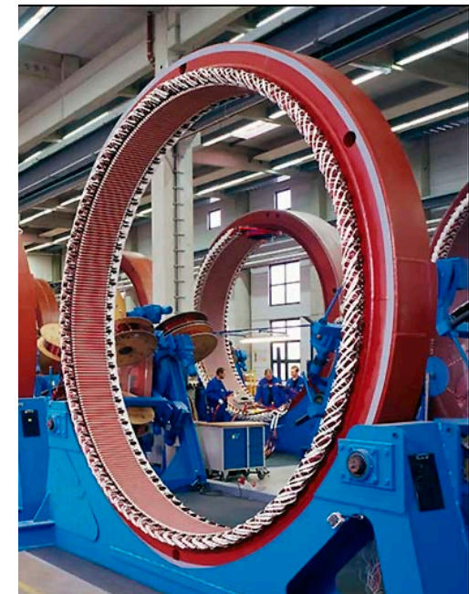
Enercon vindkraftverk Stator 2,3 MW generator Rotor: 60 poler, 6-22 rpm Turbinrotor: \varnothing 82 m
