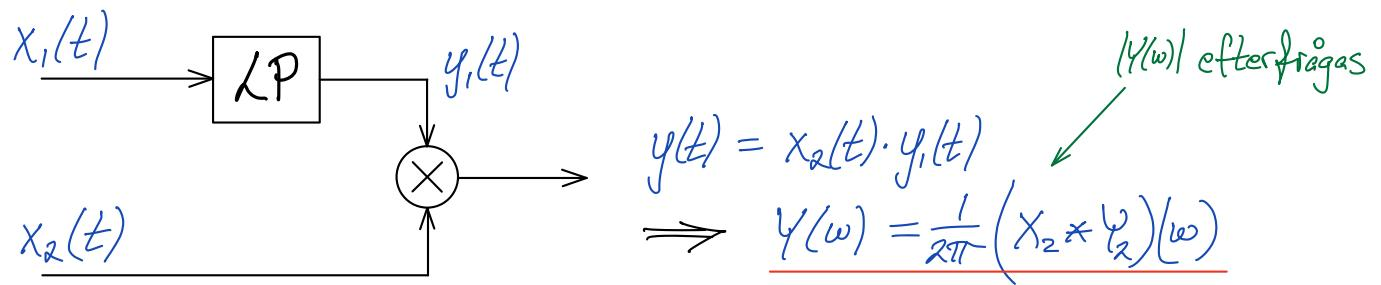
Det ideala LP-filtret släpper bara igenom frekvenskomponenter med vinkelvinkelfrekvens  $\omega < \omega_0 = 80\pi$  rad/s.
